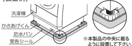
※本製品の中央に載るように設置して下さい。
