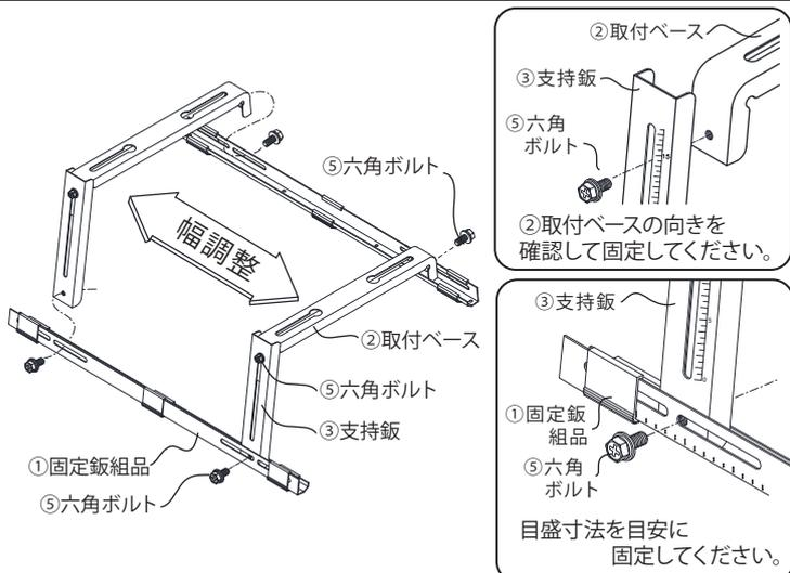
**2** 屋根勾配に合わせて角度調整を行い、室外機固定寸法に合わせて④固定ボルトを取り付けます。
