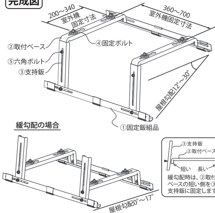
※瓦屋根の場合は、滑り止めゴムが瓦に接する様に取り付けてください。
