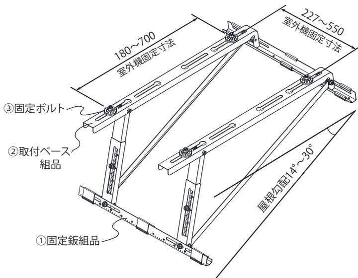
※瓦屋根の場合は、滑り止めゴムが瓦に接する様に取り付けてください。
