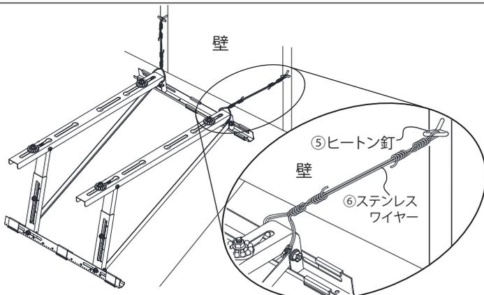
※最後にボルト等の緩み、締め忘れがないか確認してください。
