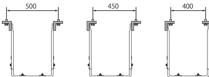
**1** ①天井固定鉋を天井に埋込まれているボルト又はナットに市販のアンカーボルト・ナットで取り付けます。
