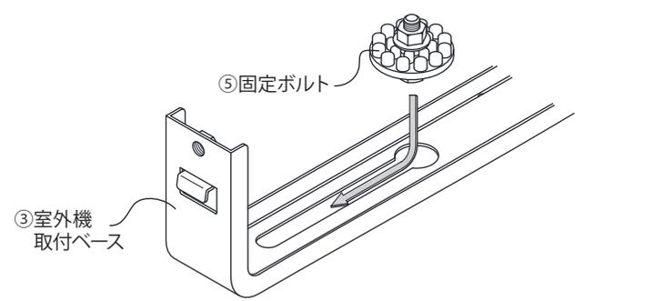
**4** 室外機本体を③組品に乗せ、⑤固定ボルトの六角ナットで固定し、③室外機取付ベースのツメ部を、②ツリカンの角穴に差し込み、⑥六角ボルトで固定します。
