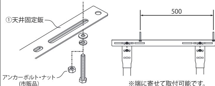
**2** 室外機固定寸法に合わせて、①天井固定鉋に②ツリカン又は④ツリカンアダプタのツメ部を引っ掛け、⑥六角ボルトで固定します。
