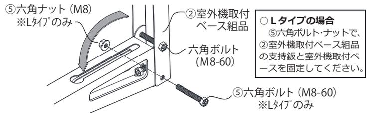
**3** 室外機固定寸法に合わせて、①壁面固定钣に②室外機取付ベース組品を引っ掛け、小ネジ(M6-15)で固定します。
