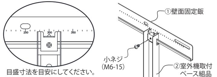
**4** ⊕ドライバーを使用して、②室外機取付ベース組品の傾きを壁面アジャスターで調整します。
