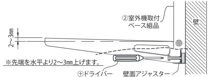
**5** 室外機固定寸法に合わせて、②室外機取付ベース組品に③固定ボルトを取り付けます。
