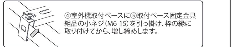
④室外機取付ベースに⑤取付ベース固定金具組品の小ネジ(M6-15)を引っ掛け、枠の縁に取り付けてから、増し締めします。
