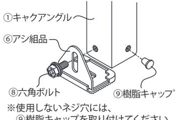
**3** ①と②の組品を⑧六角ボルトで組み立て、段差調節を行います。
