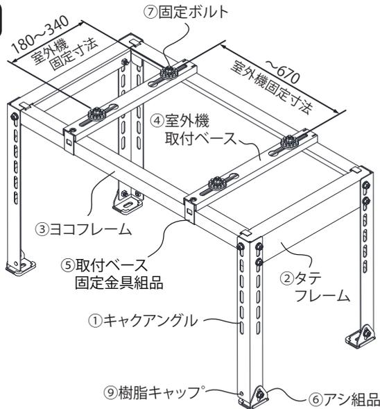
**4** 室外機固定寸法に合わせて、④室外機取付ベースの一方を枠(ヨコフレーム)に引っ掛け、⑤取付ベース固定金具組品を差込み、小ネジで固定します。
