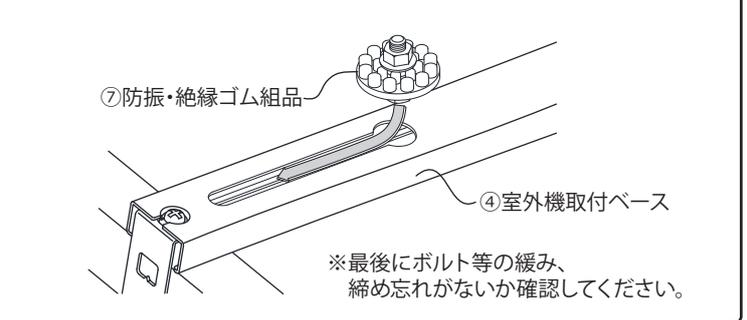
※最後にボルト等の緩み、締め忘れがないか確認してください。
