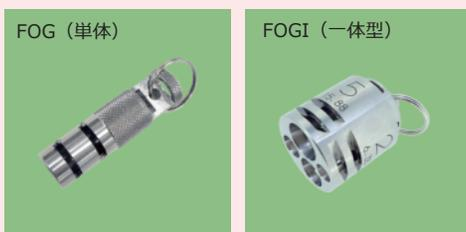
※接続部の銅管寸法が許容範囲内に入っているかの確認に使用します。問題無ければ、継手の管挿入量を目視確認する標線を2本マーキングします。
