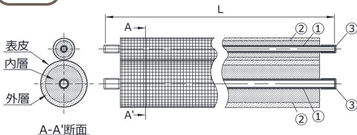
◎冷媒用被覆銅管ペアチューブ [ガス管高断熱] 共通
